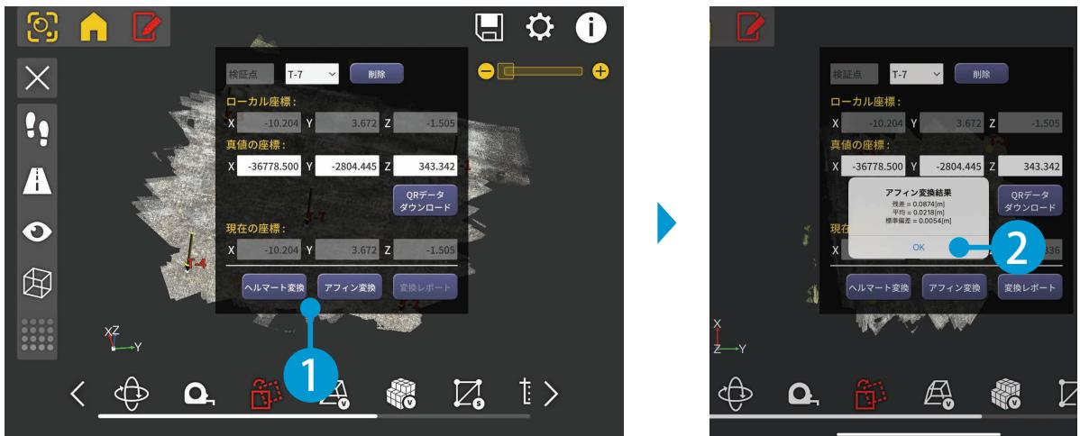
2 [変換レポート] をタップし、検証点の座標較差を確認します。
