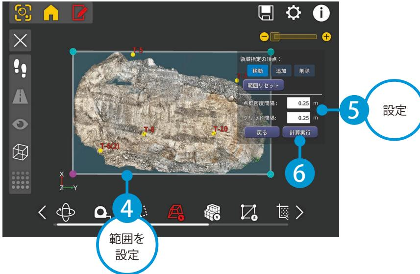
4 基準となる DL 面（水平面）の高さを設定します。
