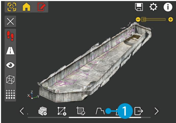
**2** スライスの基準線を指定します。基準線の起点・終点をタップします。
