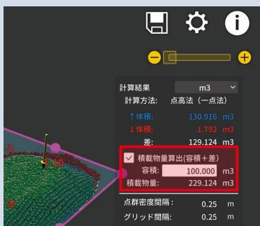
「積載物量算出（容積 + 差）」にチェックを付け、容積に数値を入力すると、積載物量を算出することができます。
