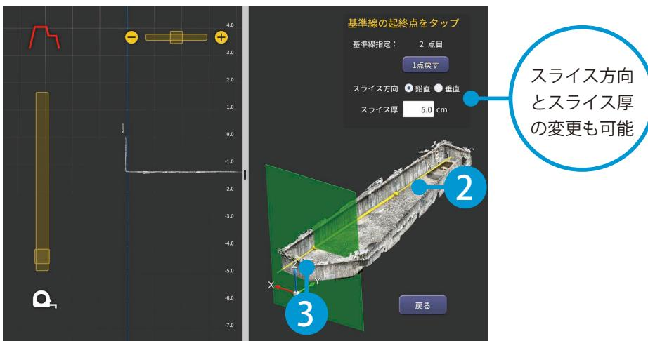
3 スライダーでスライス位置を調整し、スライスされた断面を確認します。
