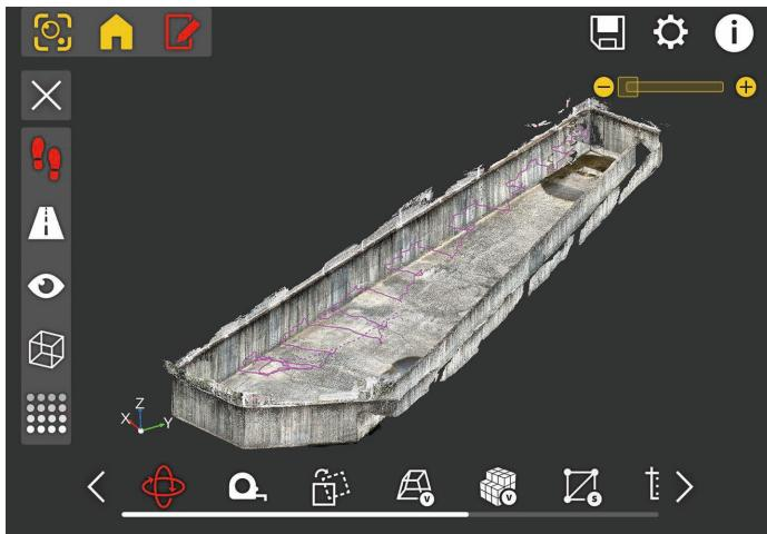
**02** | スライスする基準線を指定し、断面を確認します。
