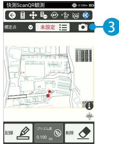
3 計測する QR プレートにカメラを向け、点名を認識させます。
