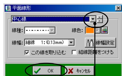
ドロップダウンボタンをクリックして選択するか、アップダウンボタンをクリックすると結線の種類を変更する事ができます。
