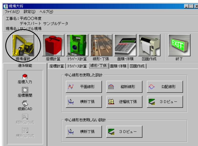
現場選択画面が表示されたら、「道路サンプルデータ」現場を選択し、「選択」ボタンをクリックします。
