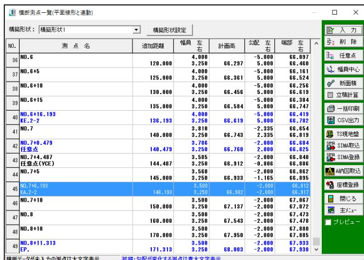
この後「立積計算」を行いますが、立積計算では2つ以上の測点に断面積が計算されていないと行う事ができません。
