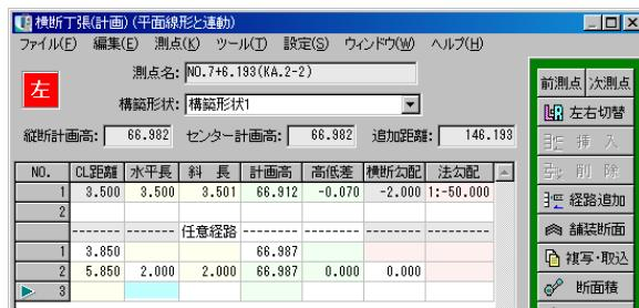
※データ入力は「CL距離・水平長・斜長」「計画高・高低差」「横断勾配・法勾配」のいずれかの組み合わせで入力します。
