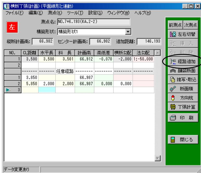
カーソルを最下行に移動して「経路追加」ボタンをクリックすると、新規の任意経路入力欄が表示されます。
